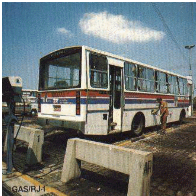
Figura 4 - Dispositivo de abastecimento de linha múltipla tipo cascata (Fonte: GASNET, 2019)
