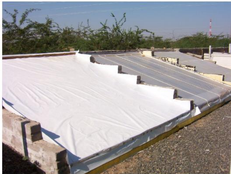
Figura 13: Condensador por Resfriamento Radiativo [15]
