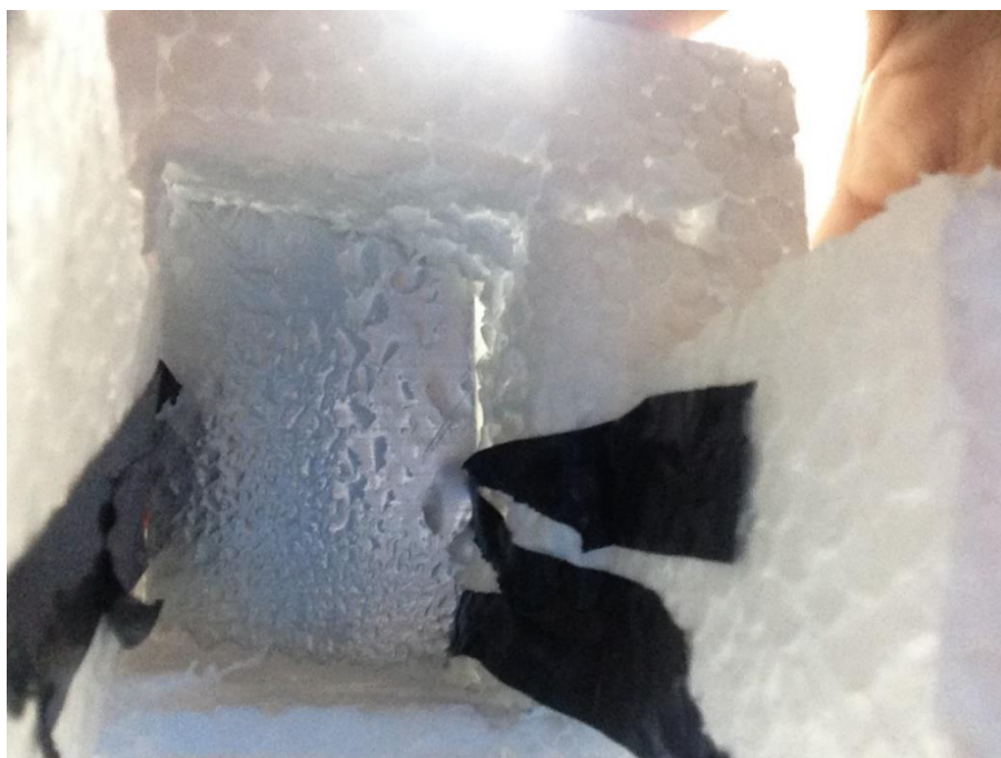
Figura 37: Formação de Filme Líquido na Superfície de Condensação durante Experimento
