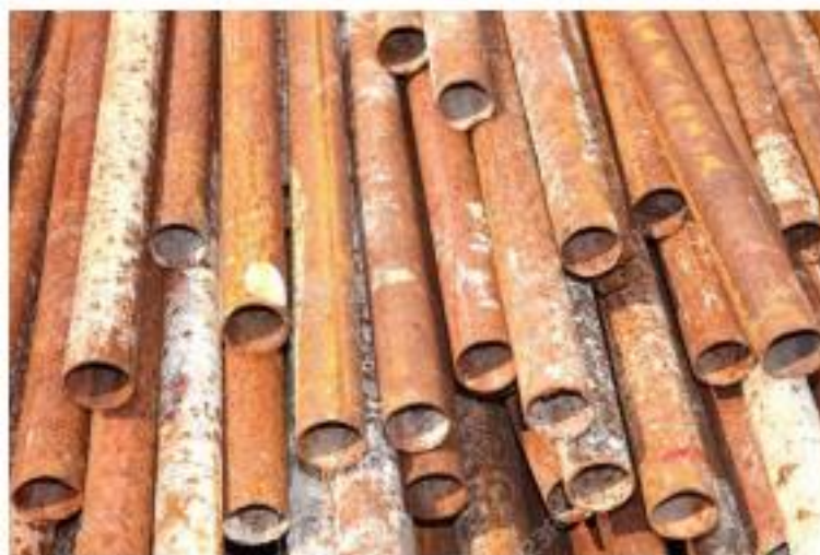
Figura 2 - Corrosão química em tubos de aço Fonte: Da Silva (2017)
