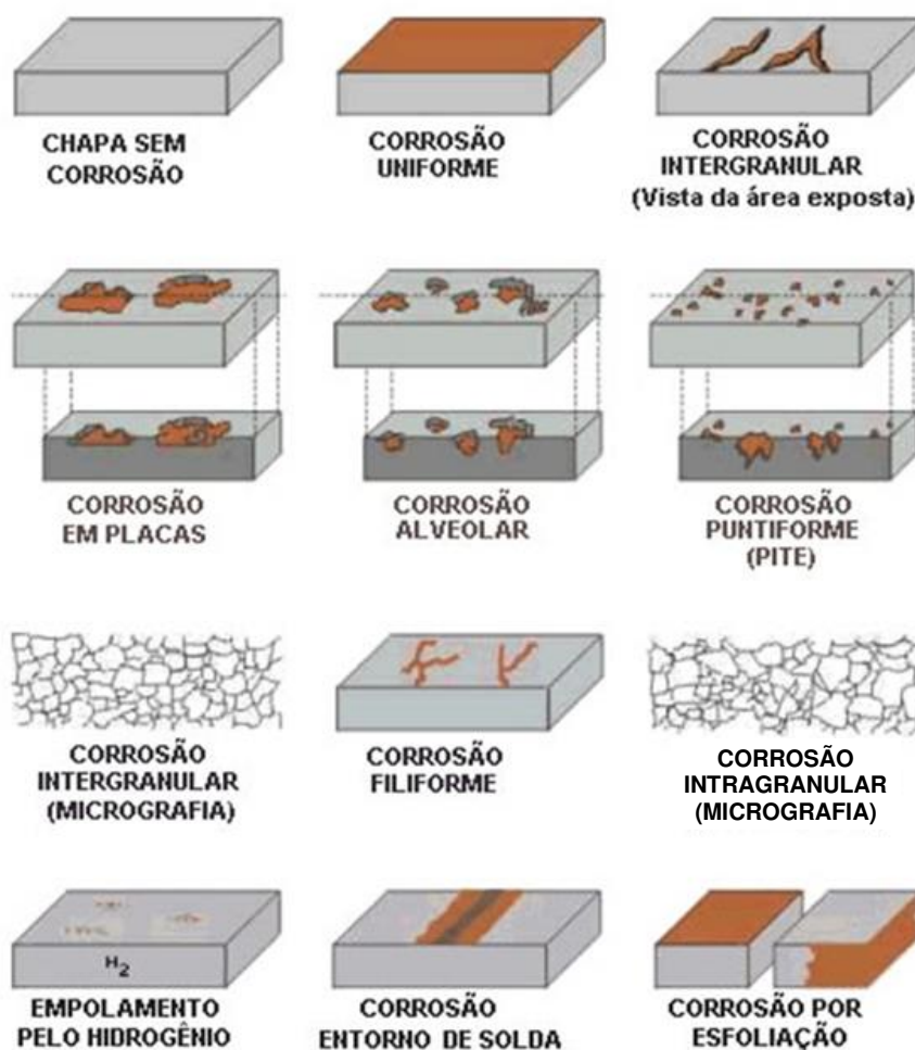
Figura 4 - Tipos de corrosão Fonte: Gentil (1996)
