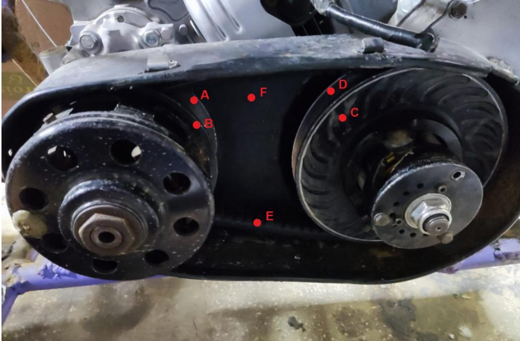
Figura 25 – Pontos de medição: (A) Prato Interno Motriz; (B) Prato Externo Motriz; (C) Prato Externo Movida; (D) Prato Interno Movida; (E) Correia; (F) Proteção Interna.
