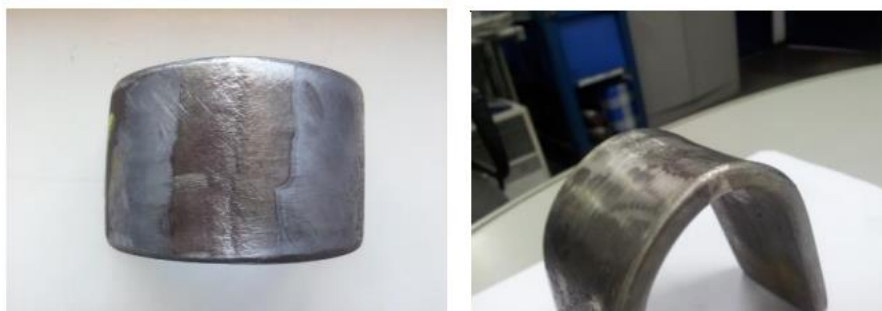
Figura 14: Corpos de prova da junta 1 após dobramento de face e de raiz, respectivamente.
