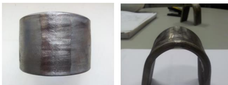
Figura 15: Corpos de prova da junta 2 após dobramento de face e de raiz, respectivamente.
