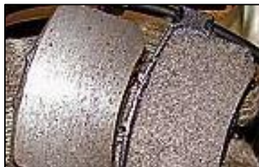
Figura 9 - Par de Pastilhas, amostra à esquerda com vitrificação [www.omecanico.com.br].
