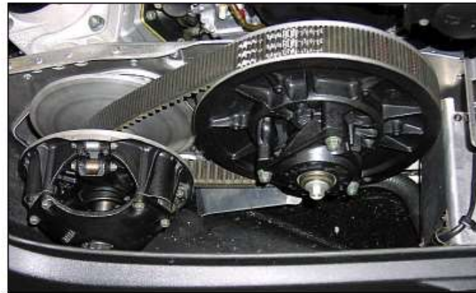
Figura 1.5 – Transmissão por correia com variação contínua (CVT) na relação de multiplicação através do deslocamento da correia sobre a polia em movimento
