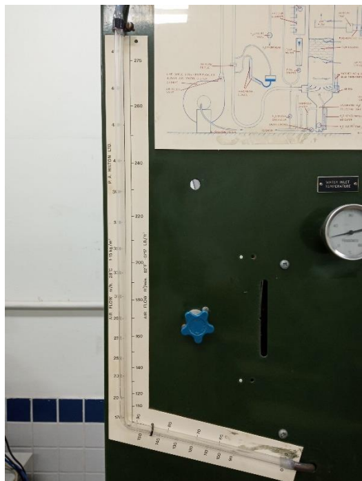
Figura 24: Medidor de vazão de ar
