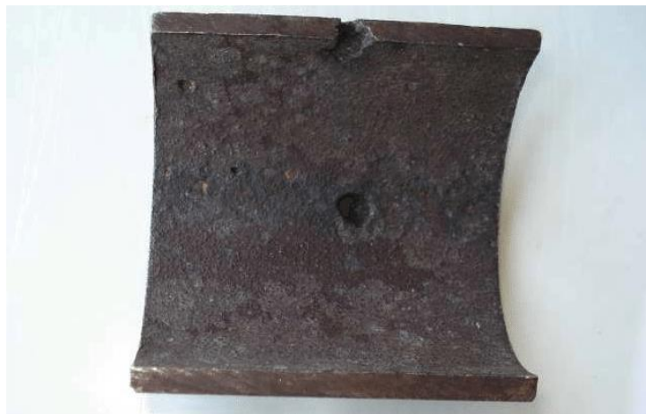
Figura 18 - Corrosão localizada. Fonte: OLIVEIRA, 2015.
