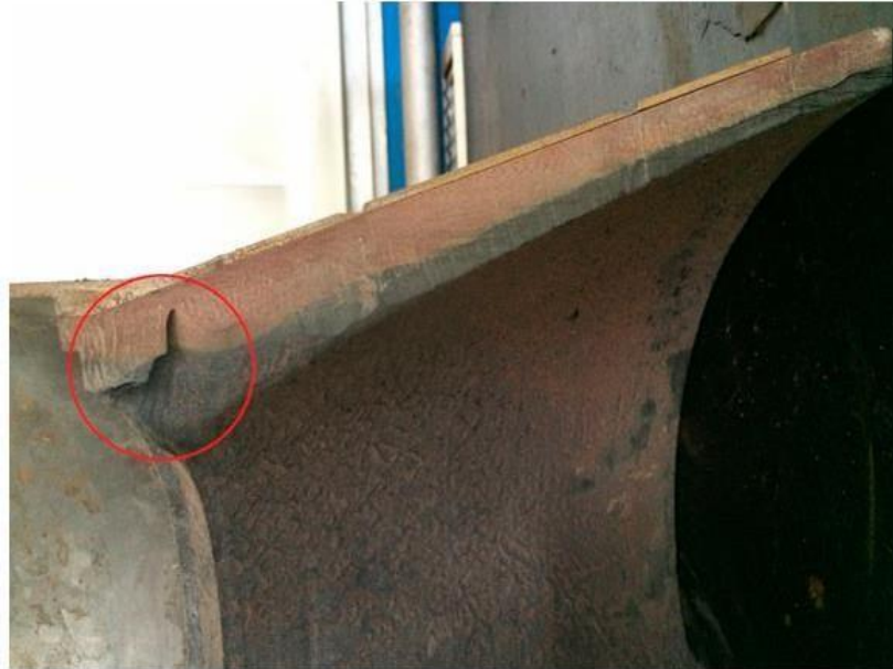
Figura 3 - Falha na região divergente do bocal, onde um furo se estende até a segunda camada na folga entre o inserto e a estrutura principal, indicando um vazamento de chama. Observa-se menor ablação e carbonização nessa região, porém a presença do furo sugere que a folga de 0,2 mm permitiu a penetração dos gases quentes, resultando em degradação localizada do material (SUN et al., 2016)
