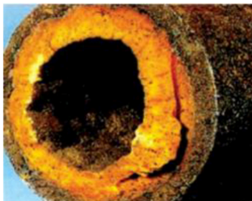
Figura 8 - Depósito De Parafina Precipitado Na Parede Do Tubo Fonte: Lemos 2018
