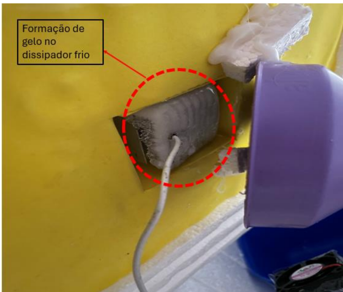
Figura 23 - Formação de gelo no dissipador frio
