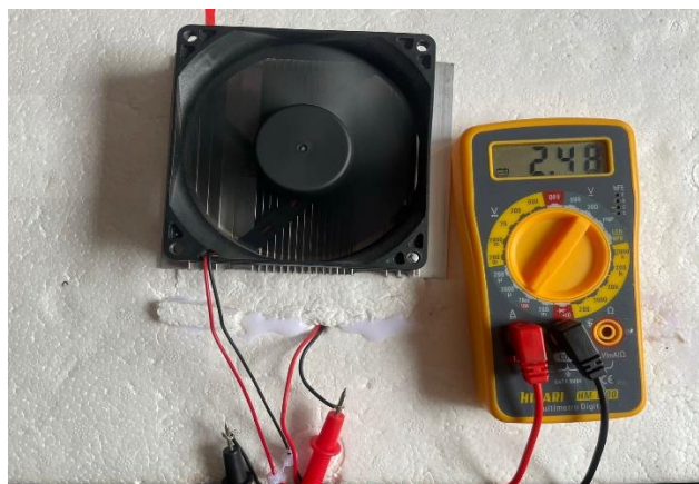
Figura 21 - Medição da corrente elétrica no módulo Peltier
