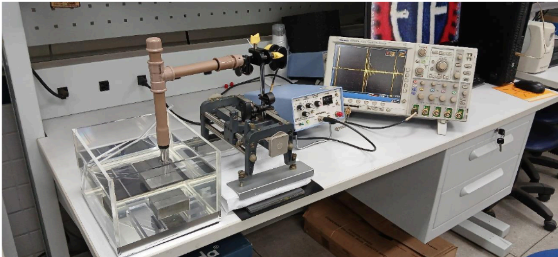
Figura 3.3 - Configuração do ensaio de Ultrassom.
