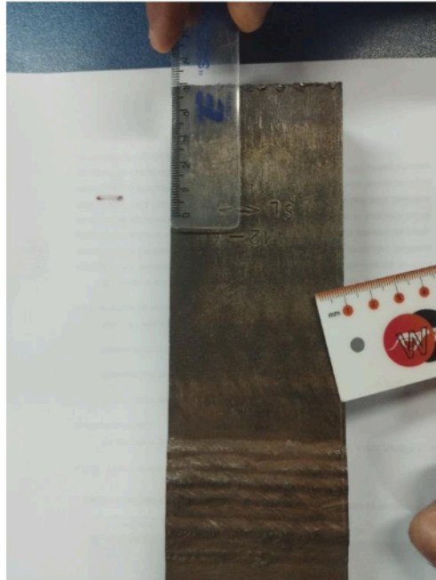
Figura 3.2 - Posição da retirada das amostras no metal base da junta soldada.
