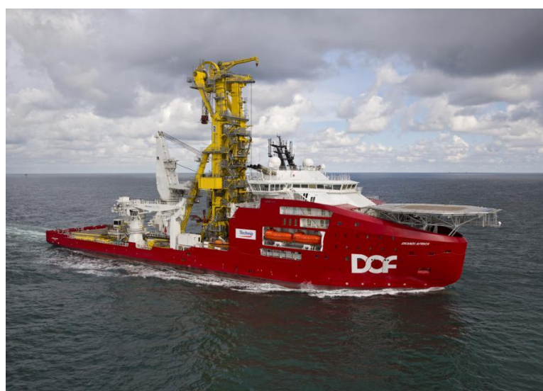
Figura 11 - Navio PLSV com torre de lançamento Fonte: Huisman
