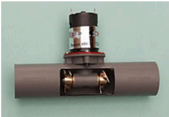
Figura 6 – Modelo em Escala de Bow Thruster
