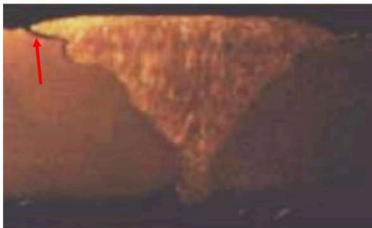
Figura 72 – Deslocamento de metal de solda Fonte: ZEEMAN, 2003
