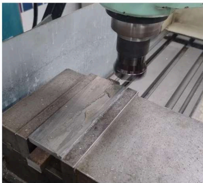
Figura 43 - Usinagem de uma das amostras após o corte Fonte: Autores
