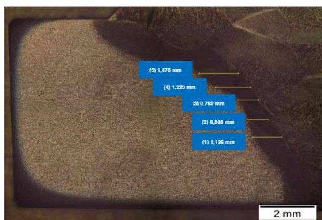
Figura 58 - Medição da ZTA do MS Fonte: Autores
