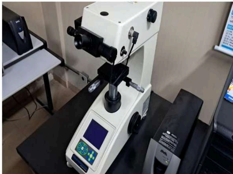
Figura 39 - Máquina utilizada no ensaio de dureza Vickers Fonte: Autores
