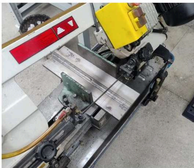
Figura 37- Posicionamento dos cortes na junta soldada
