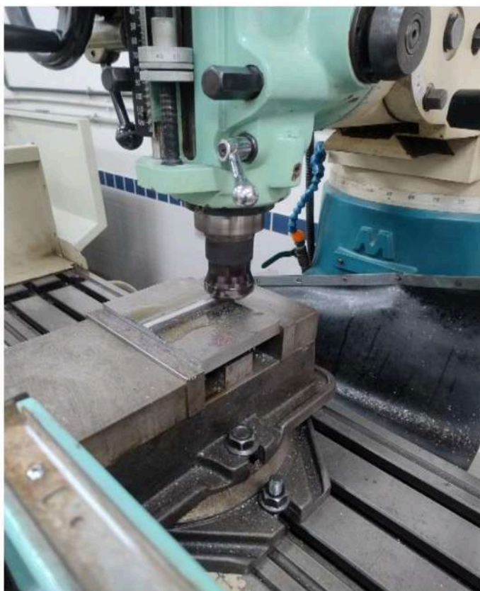
Figura 42 - Início do desbaste da placa na fresadora Fonte: Autores
