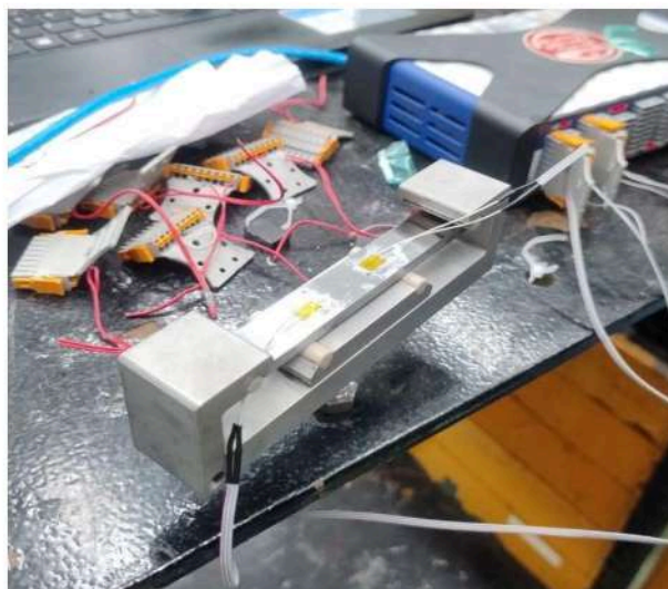
Figura 45 - Montagem do Strain Gauge antes do ensaio Fonte: Autores
