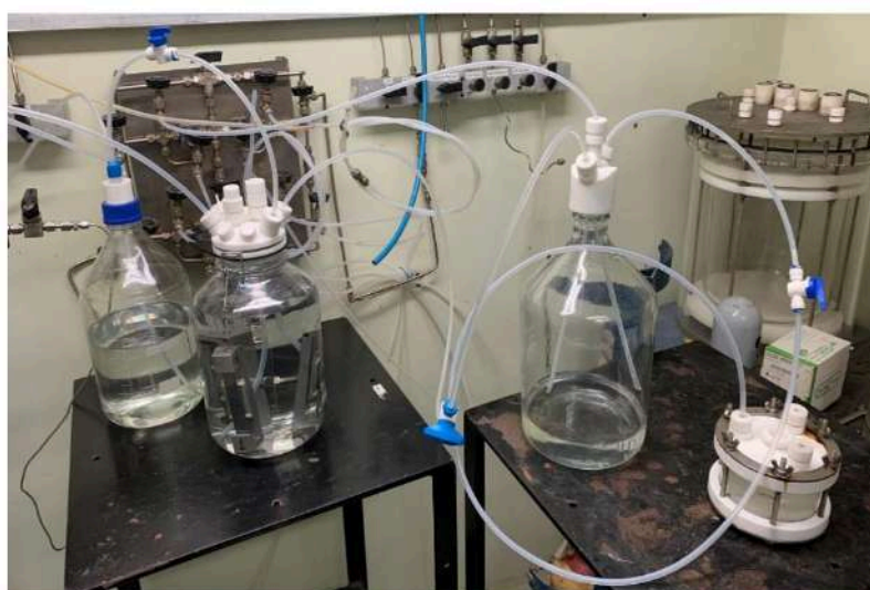
Figura 51 - Início do teste de corrosão em H_2S Fonte: Autores
