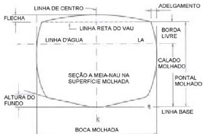
Figura 5: Dimensões lineares da seção transversal
