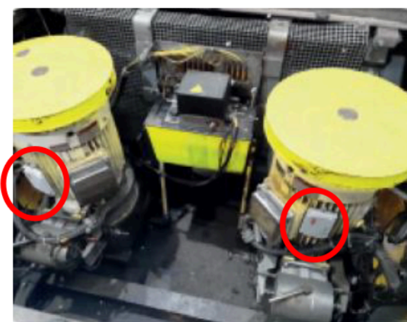
Figura 25 – Dispositivo inteligente acoplado ao motor elétrico – Estudo de Caso
