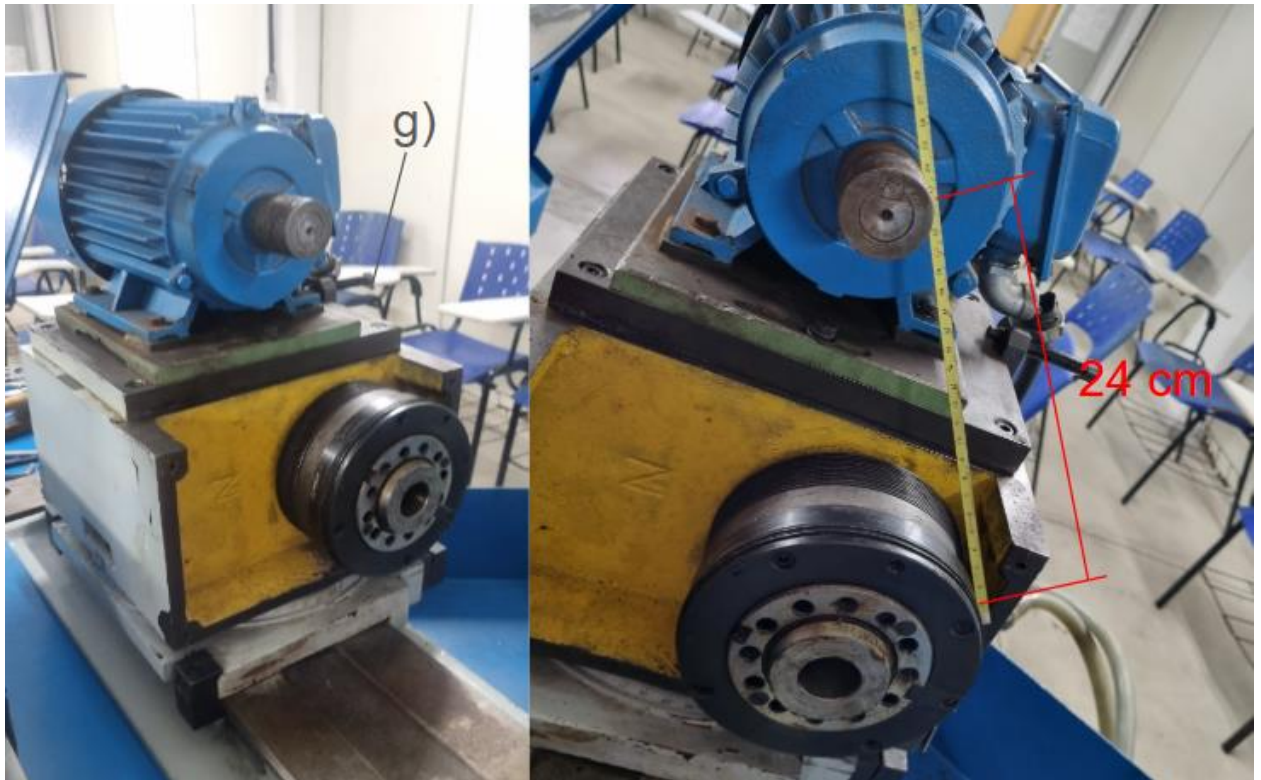
Figura A-2: Transmissão do cabeçote porta-peças
