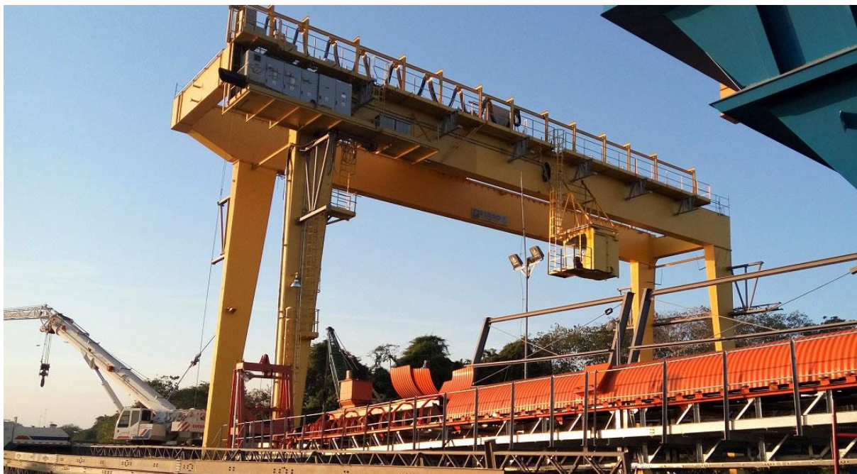
Figura 6 - Pórtico Biviga Fonte: Ferro Indústria (2023)
