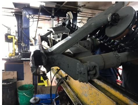
Figura 5. Sistema de molas para engate
