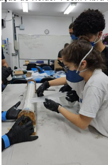
Figura 2 - Laminação do Helder 1 com Fibra de Vidro.
