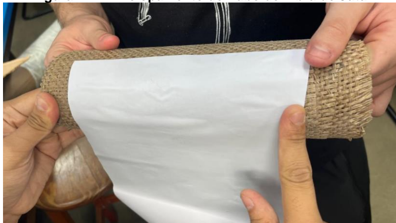
Figura 12 - Envelopamento do Tubo de Fibra de Juta.
