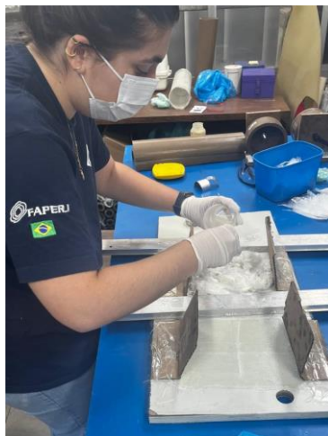
Figura 3 - Foto Durante a Laminação da Fibra de Bambu.
