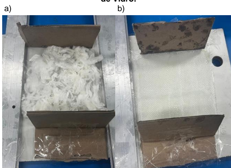
Figura 4 - Foto da Primeira Camada das Fibras no Molde, sendo a) Fibra de Bambu e b) Fibra de Vidro.
